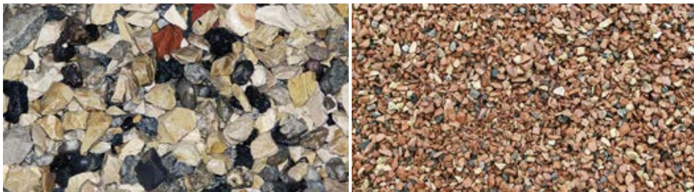
Deux produits en échanges: des granulats non triés lavés (20 – 40 mm) et des granulats de tuiles (6 – 16 mm).
