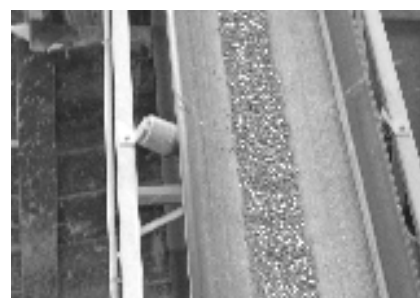
Séparation des fractions fines obtenues suite au tri mécanique de déchets de chantier tout-venant.
