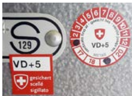
Une marque de vérification visible, rouge et blanche, indiquant la date de la prochaine vérification, est apposée sur l'instrument.
